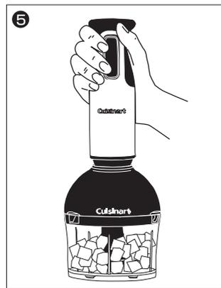
⑤ グリップ部に手のひらを合わせ、スイッチ部に指が当たるように持ちます。スイッチをONにして食材をくだきます。スイッチを押したり放したりして断続運転(PULSE)させると、野菜をみじん切りするとき効果があります。
