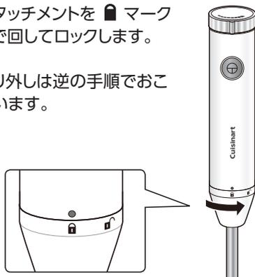
本体とアタッチメントのクラッチ部は樹脂で作られています。取り付けが不十分な場合、クラッチ部が損傷する原因になりますので、アタッチメントは確実に 🔒 マークに合わせて固定してください。
